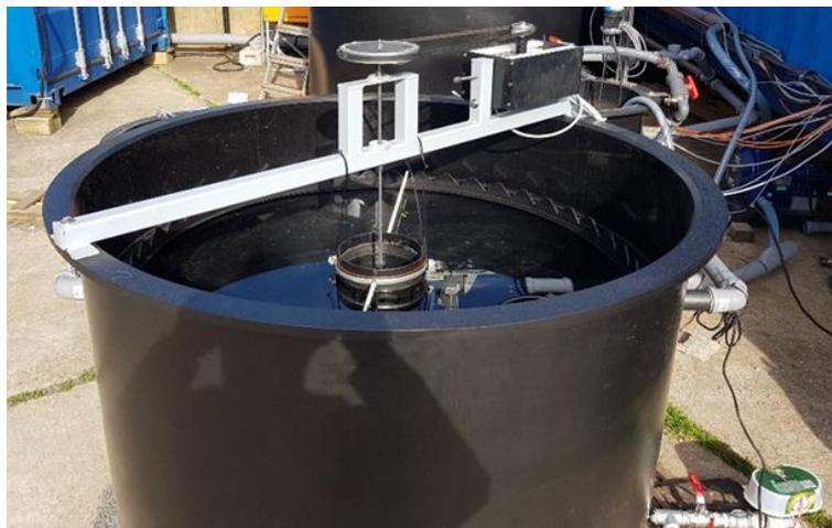
**Abbildung 3-9: Nachklärbecken mit Motorstellventil**
