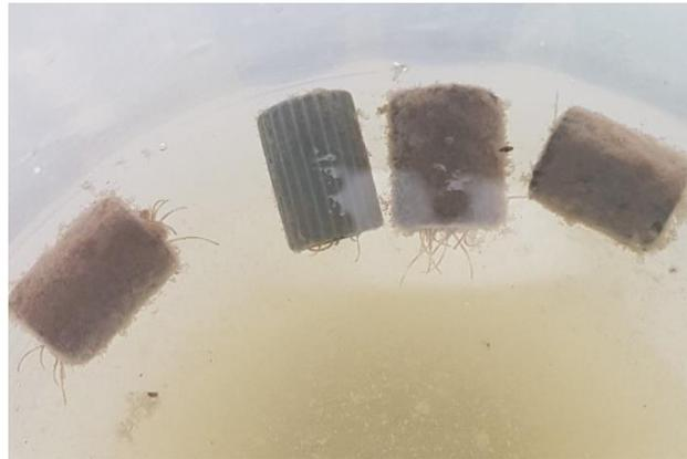
**Abbildung 5-9: Wurmbefall auf dem Trägermaterial des SBF**
